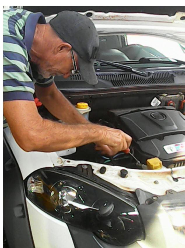
A instalação do dispositivo é fácil e pode ser feita em carros movidos à álcool e à gasolina
